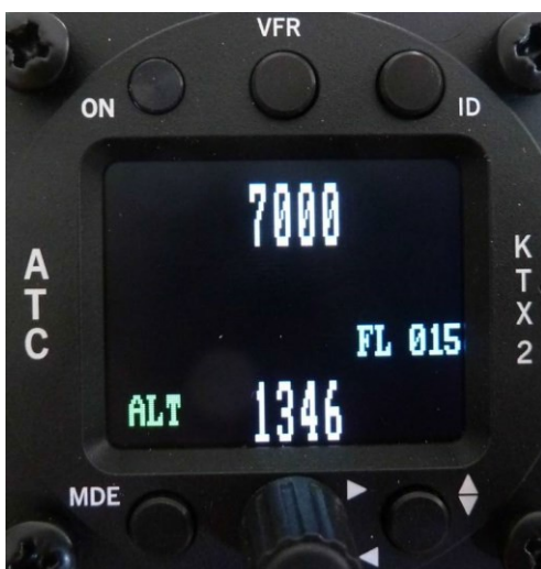
Kein GND Schalter installiert
