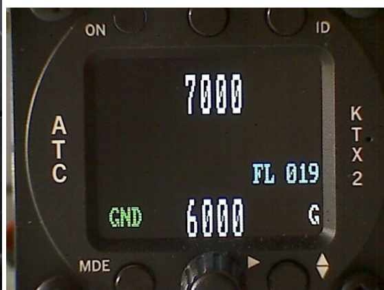
GND Schalter installiert, am Boden
